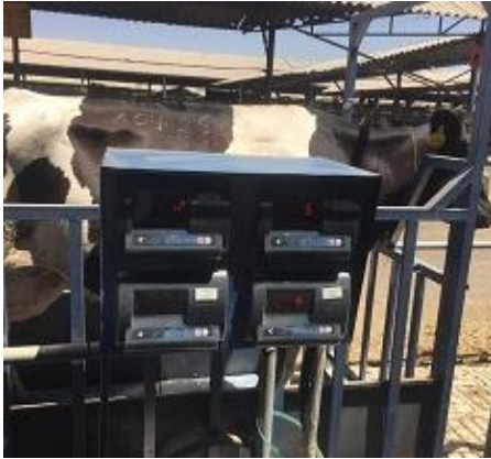
تصویر ۲: باسکول طراحی شده بر اساس نتایج بدست آمده از فواصل بین اندام‌های حرکتی از یکدیگر
