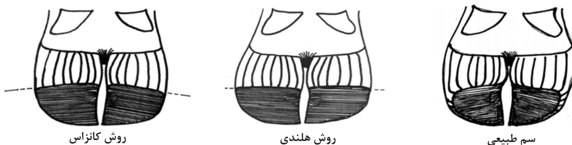
شکل ۸. نمایش سطوح وزن‌گیری در شرایط طبیعی و مقایسه‌ی دوروش برداشت کف به روش های هلندی و کانزاس (برداشت به روش کانزاس خیلی نزدیک‌تر به شیب طبیعی کف است).
