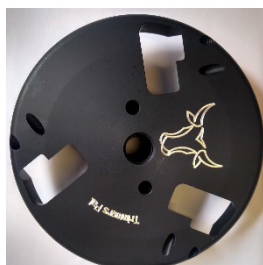
شکل ۷: صفحه سم‌چینی با تیغه‌های ثابت و غیر قابل تعویض
