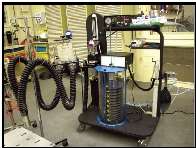
شکل ۶: دستگاه بیهوشی استنشاقی با ونتیلاتور - (راست) دام بزرگ، (چپ) دام کوچک
